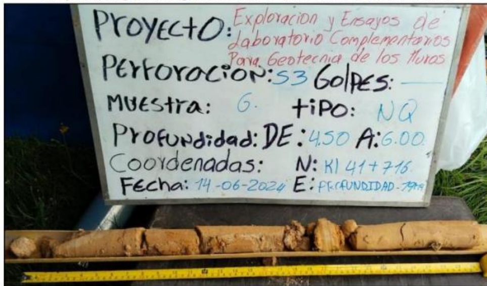
Imagen 1. Registro fotográfico sondeo 3 muestra de 4.5 a 6.0 metros
