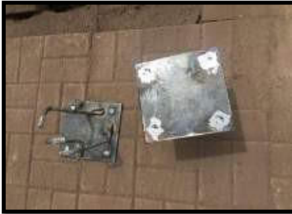
PLATINA DE SOPORTE PARA COLUMNAS
