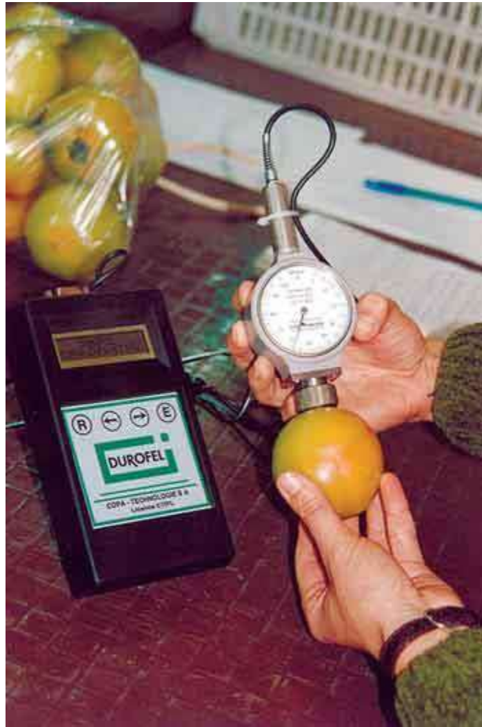
Figura 12: Medición de la firmeza de un fruto mediante métodos objetivos.
