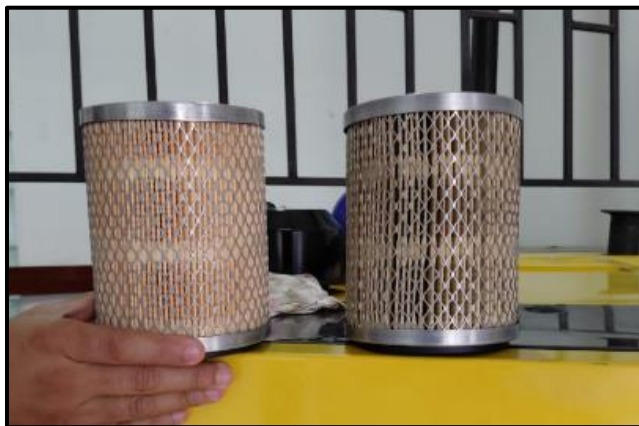
Ilustración 96 Cambio de filtro de aire del generador
