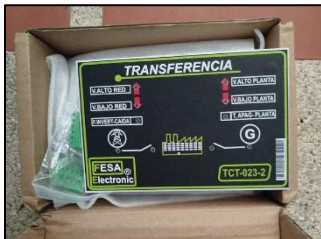
Ilustración 119 Suministro de transferencia electrónica automática
