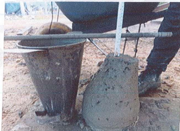
Ilustración 10. ensayo de asentamiento del concreto o prueba del cono de Abrams (slump)
