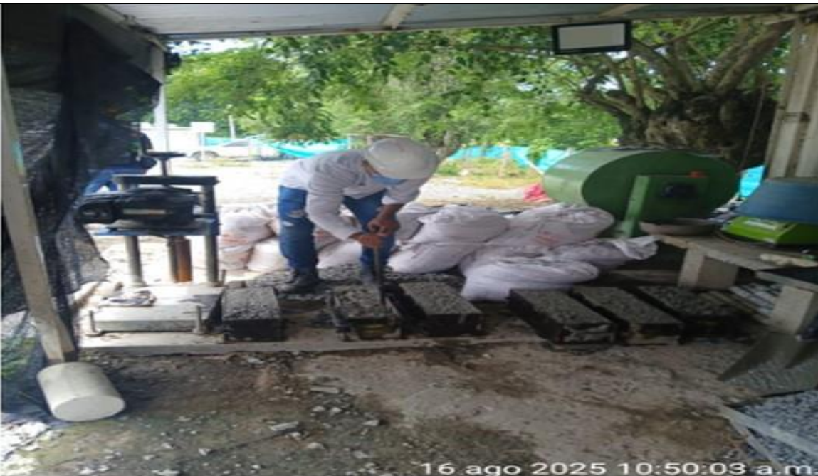
PR9+700 al PR 9+713 lado derecho. Toma de muestras de concreto MR40.
