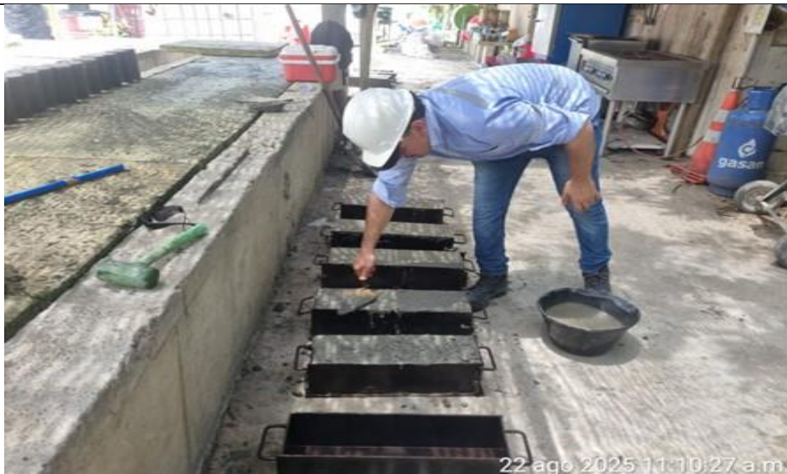
PR 4+400 lado derecho. Toma de muestras y asentamiento al concreto MR-40.
