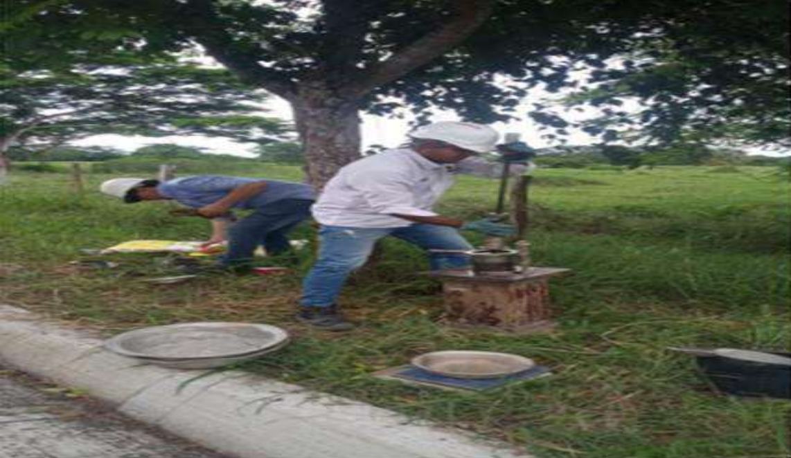
PR 3+580 carril derecho. Muestreo mezcla MDC-19.
