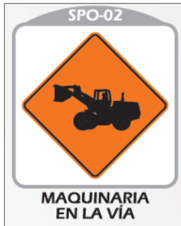
Figura 8. SPO-02 Maquinaria en la vía.
