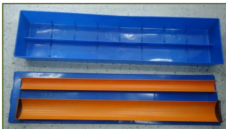
Figura 9. Caja azul estándar de la Litoteca Nacional. (sobre la tapa se aprecian además las canaletas de PVC)
