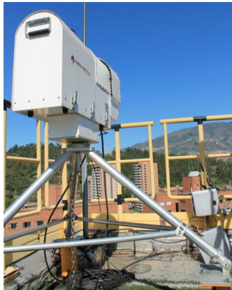
Figura 1. Radiómetro microondas MP3000A instalado en Torre SIATA.
