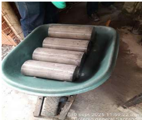
Ilustración 39: Retiro de muestras de concreto por la empresa Concrelab
