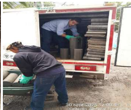
Ilustración 39: Retiro de muestras de concreto por la empresa Concrelab
