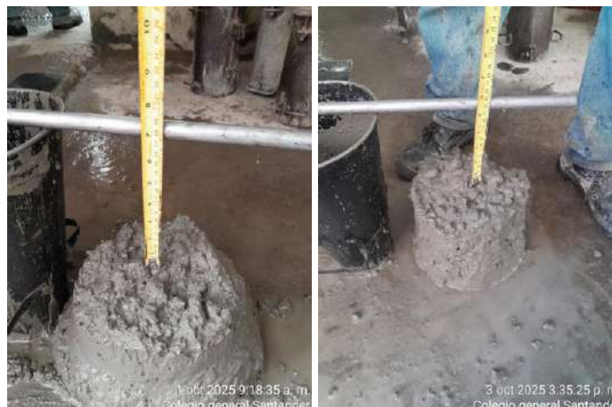
Ilustración 36: Prueba de Slump
