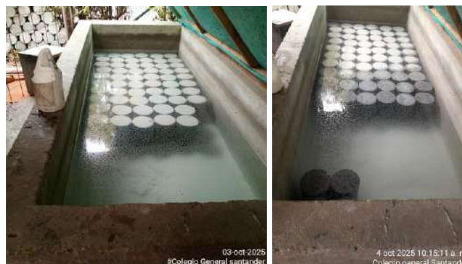
Ilustración 38: Muestras de concreto sumergidas en agua.
