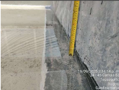
13. Prueba de estanquidad en área S.
