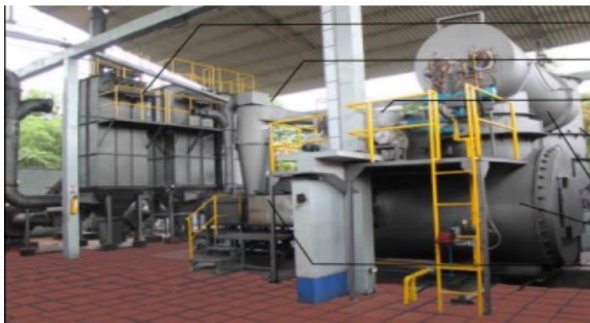
Figura 3. Equipo de incineración y sistemas de control atmosférico
