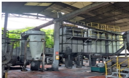
Fotografía 1. Unidad de incineración y sistemas de control de emisiones atmosféricas.
