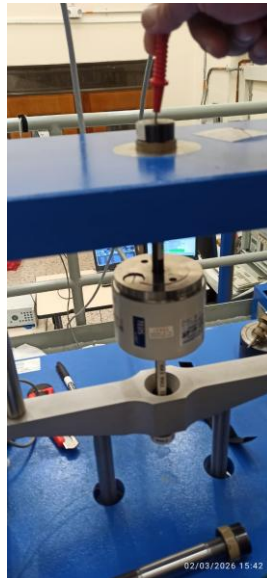
Figura A1-1. Medición de tensión en el patrón de 10 kN con multímetro YF-3210: lectura de 46,1 V CA entre el transductor y tierra. 02/03/2026, 15:41 h.
