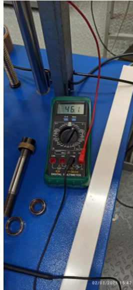
Figura A1-3. Toma de medición con punta de prueba sobre el transductor montado en el patrón de 10 kN. 02/03/2026, 15:42 h.
