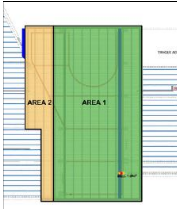
Imagen 2. Áreas de Drenaje por Bajante Proyectada
