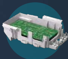
Caja eléctrica sellada con revestimiento engrosado en la PCB.
