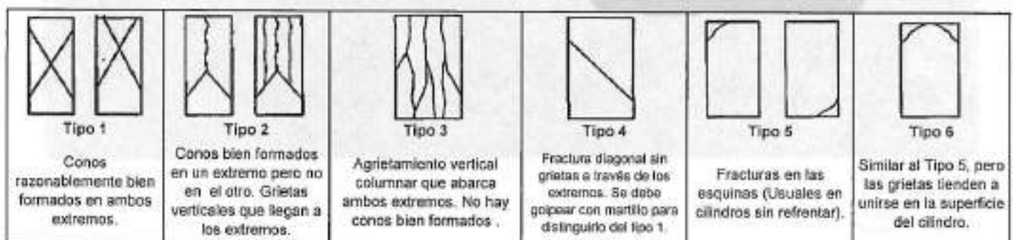
Figura 410 - 3. Esquemas de patrones de falla típicos
