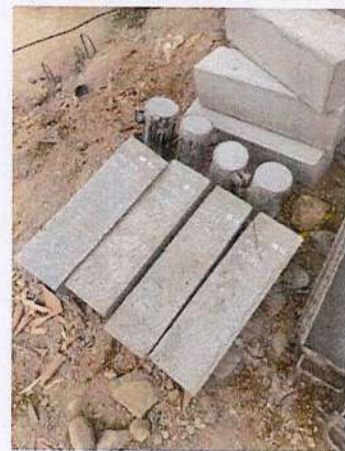
Muestras de concreto desmoldadas para iniciar proceso de curado y fallar en los próximos días.
