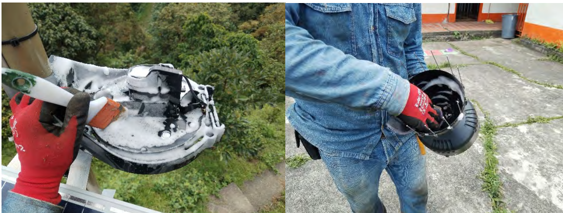
Ilustración 128: Limpieza sensor pluviómetro.
