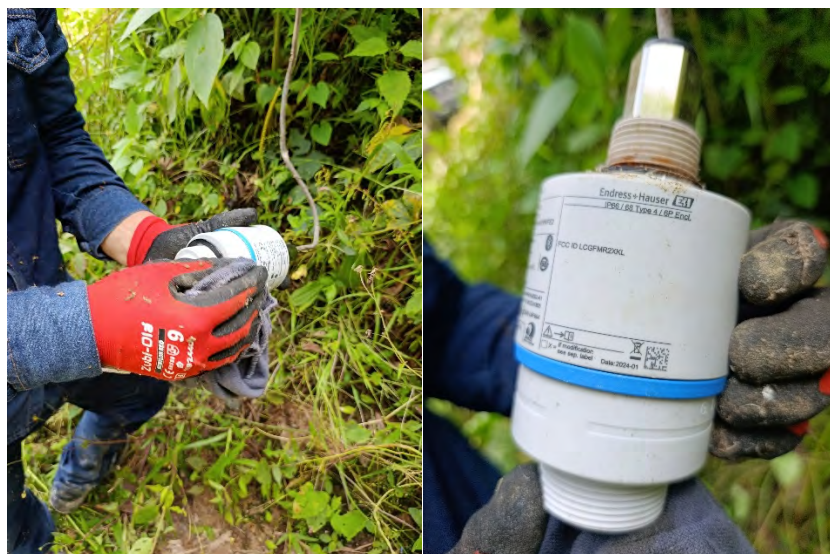
Ilustración 4: Limpieza de sensor de nivel.
