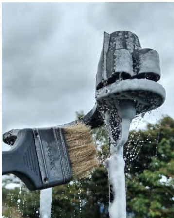
Ilustración 18: Limpieza de sensor de UV.
