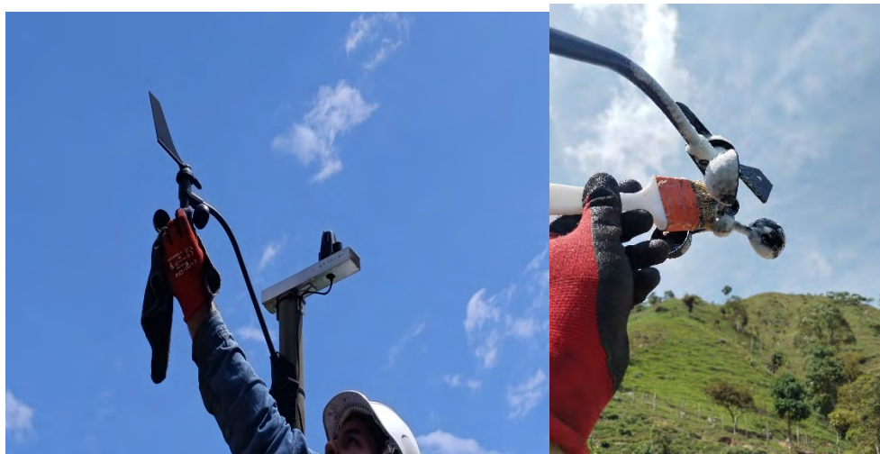
Ilustración 30: Limpieza sensor anemómetro.
