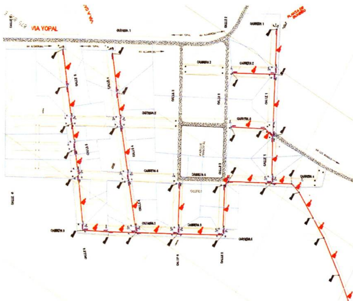
IMAGEN 2. RED ALCANTARILLADO PLUVIAL.
