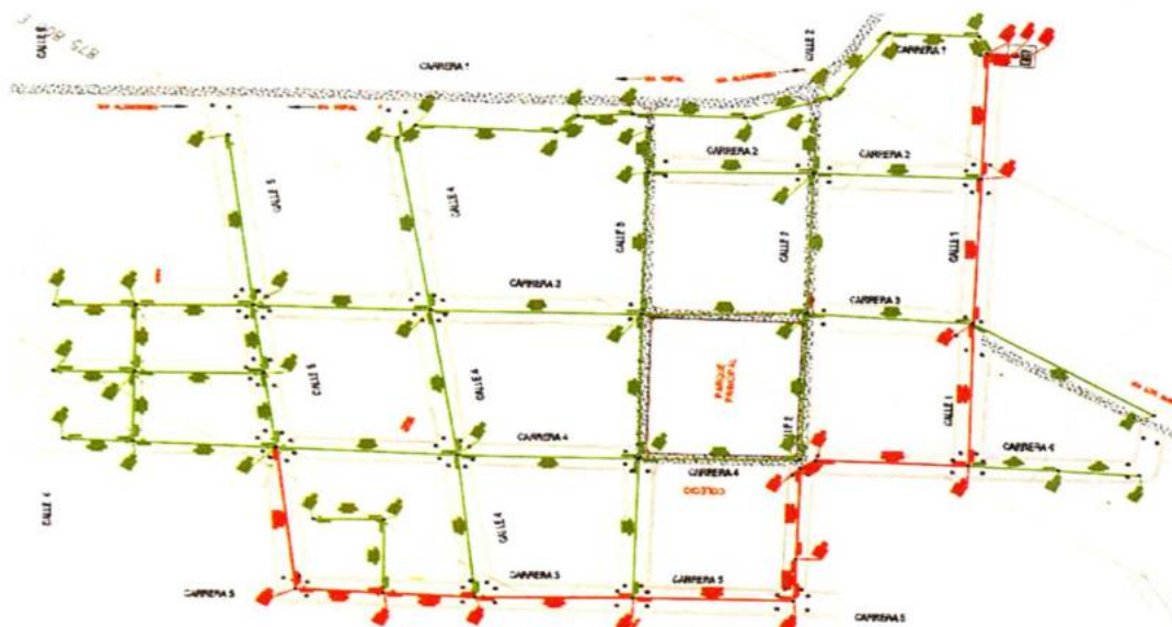
IMAGEN 3. RED DE ALCANTARILLADO SANITARIO.
