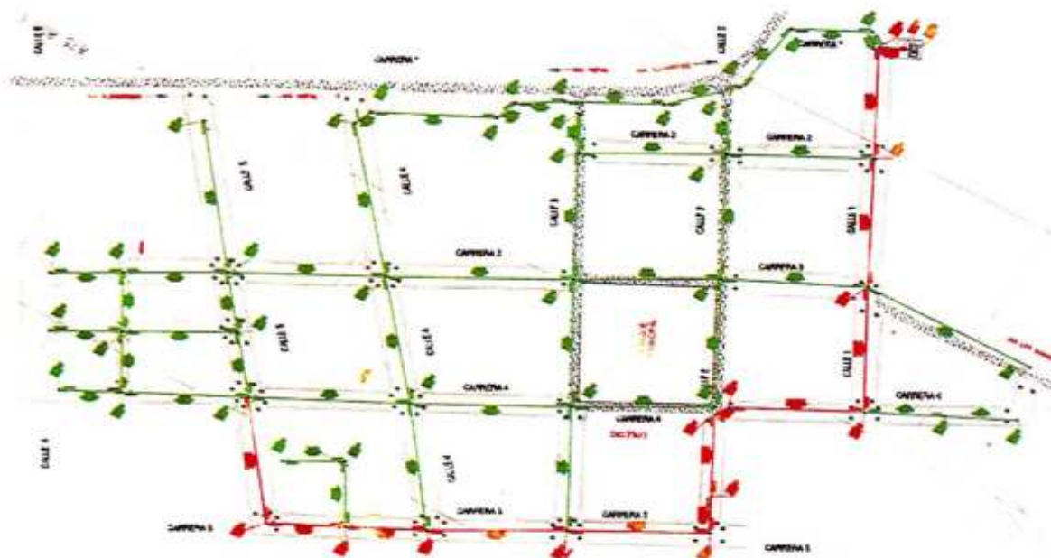
IMAGEN 3. RED DE ALCANTARILLADO SANITARIO.
