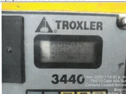
FOTO No. 130. Se revisa y verifica la lectura de los resultados de las pruebas de densidades parque, URBANIZACIÓN LA ESTANCIA 19-039
