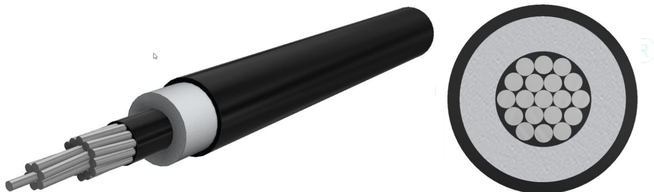
Figura 4. Cable AAAC monopolar cubierto XLPE/HDPE 90°C (19 hilos)
