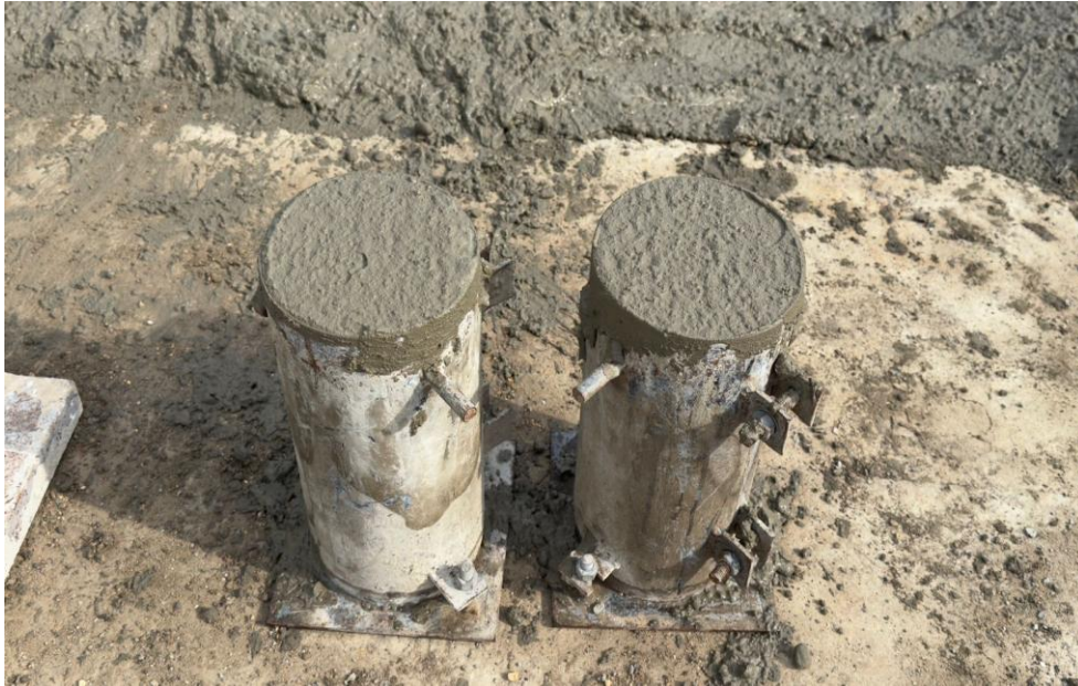
Ilustración 73. Toma de muestras concreto 4000 psi para placa baños cancha futbol 9
