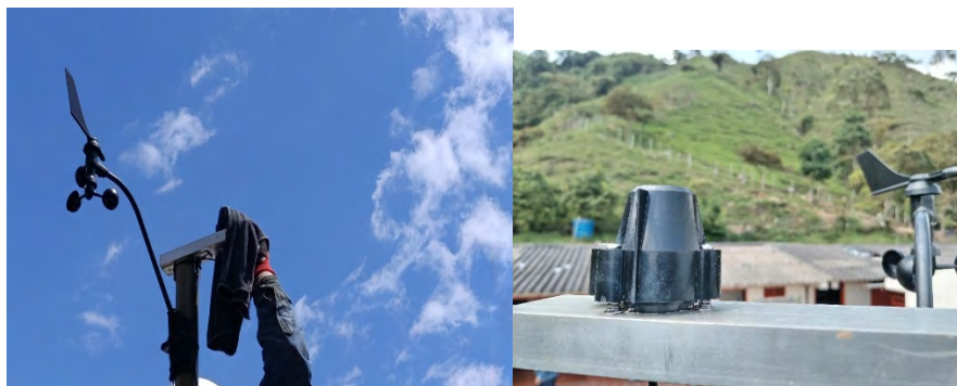
Ilustración 31: Limpieza sensor de radiación solar
