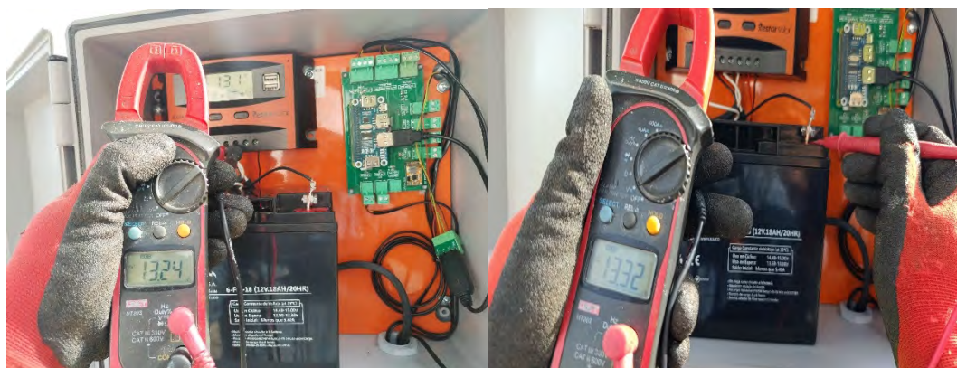
Ilustración 142: Medición de voltaje de batería 13.3V y estado de batería ok.
