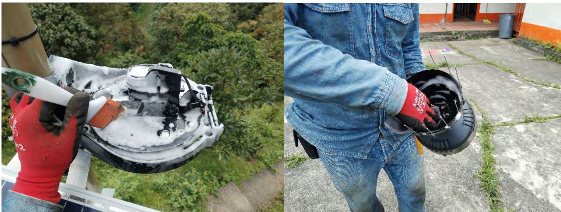
Ilustración 128: Limpieza sensor pluviómetro.
