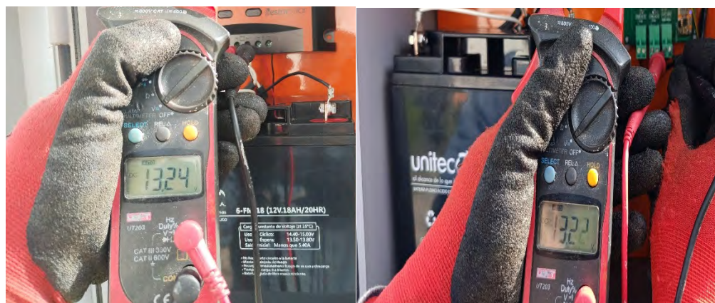
Ilustración 22: Medición de voltaje de batería 13.24V y estado de batería ok
