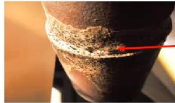
Unión sobrecalentada, pequeñas burbujas
