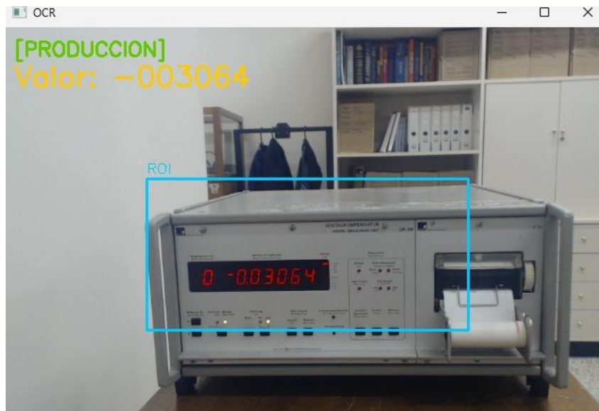
Figura 3 - Sistema de reconocimiento con cámara web.
