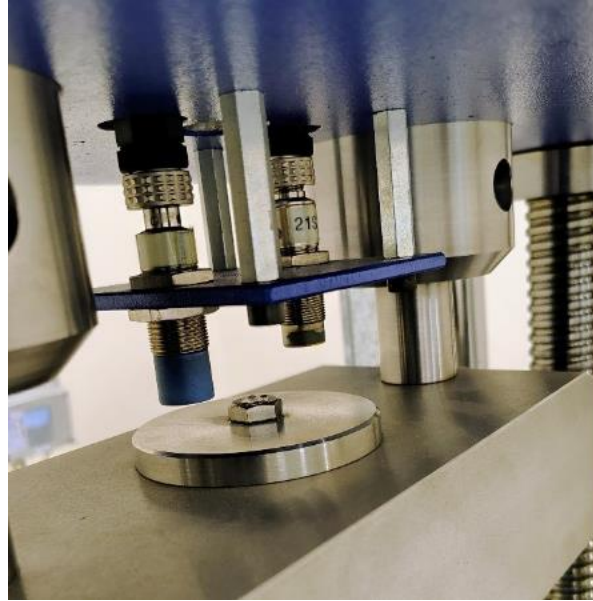
Figura 2e: Sensores de proximidad instalados en la parte superior del bastidor.
