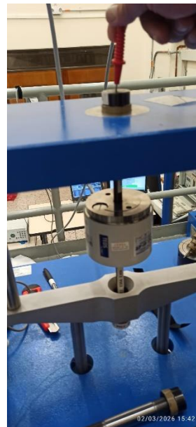
Figura 16, detalle del montaje utilizado para la medición de tensión entre el IBC y la estructura de la máquina durante el mantenimiento.
