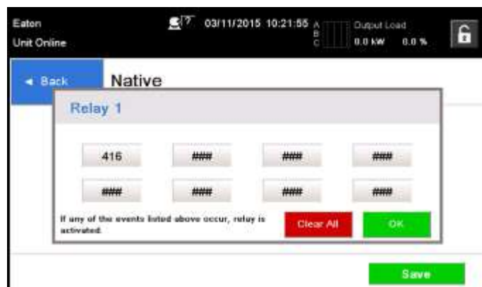
Figura 45. Introducción de los códigos de las funciones que activarán el relé
