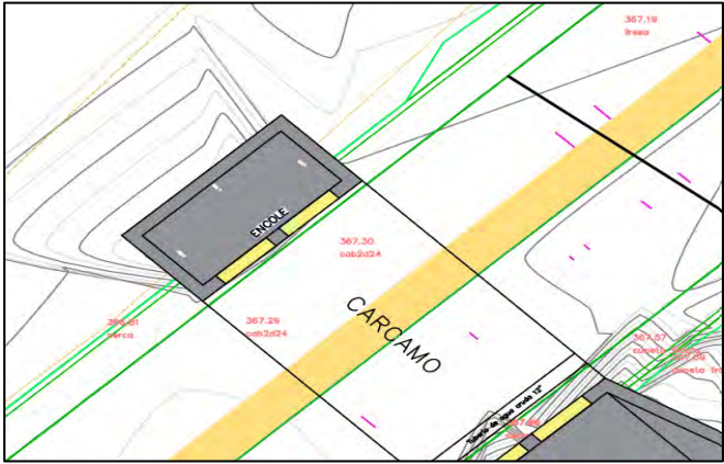
Ilustración 6. Esquema de la Alcantarilla en Finca Caracolí- Vereda en Hobal
