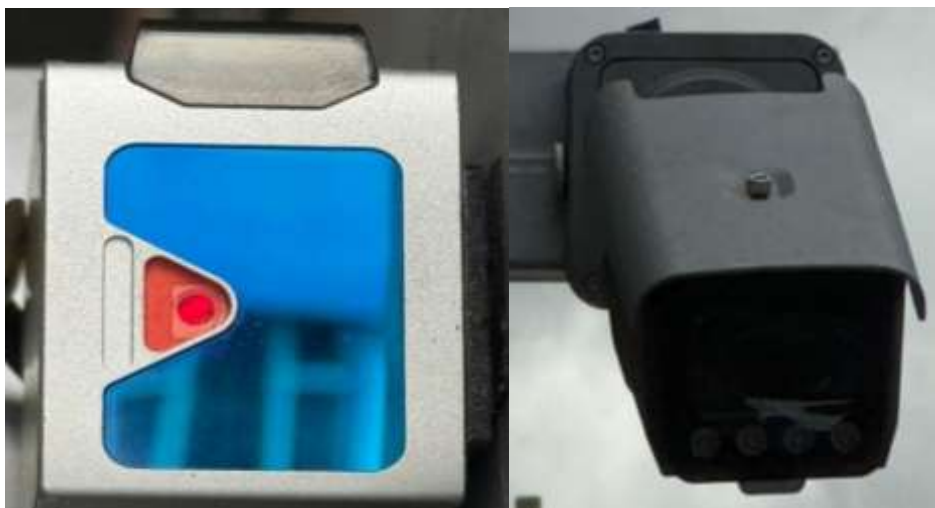
Sensores o Cámara LPR
