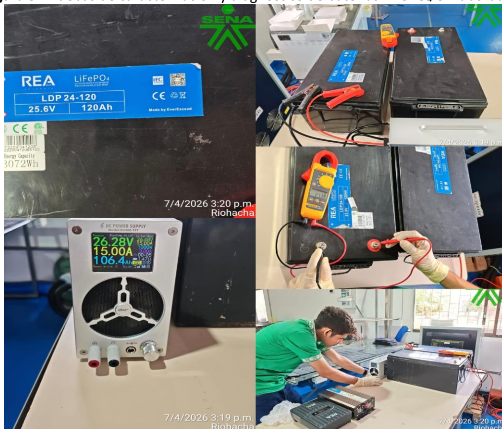
Figura 3. Pruebas de caracterización y diagnóstico de baterías \text{LiFePO}_4 en laboratorio
