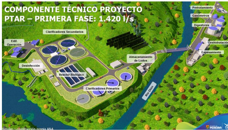
Figura 3.1. Componentes e infraestructura principal
