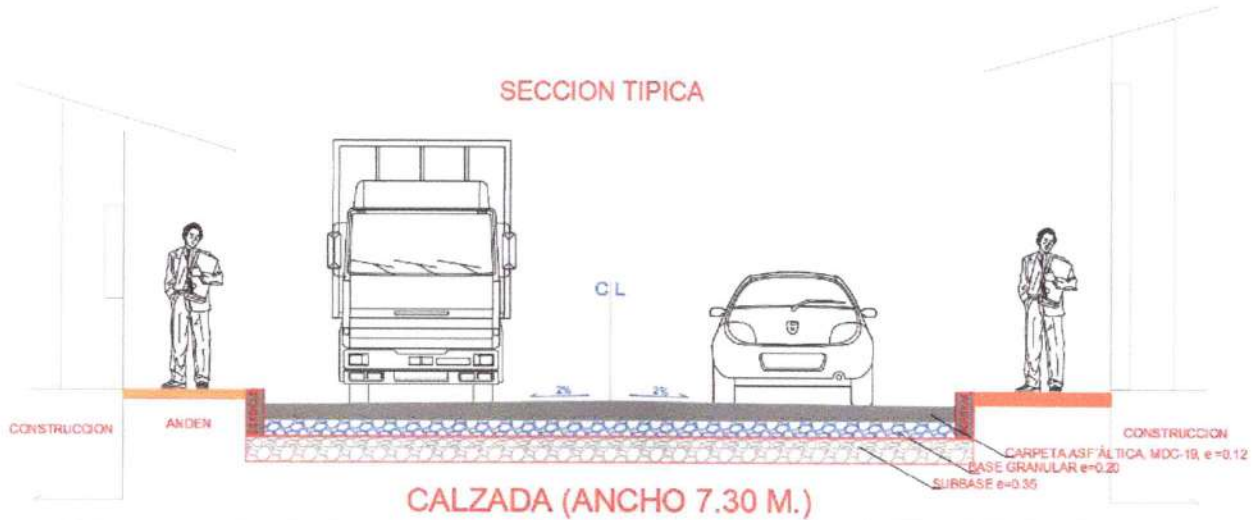
Figura No. 1 Sección Transversal Típica
