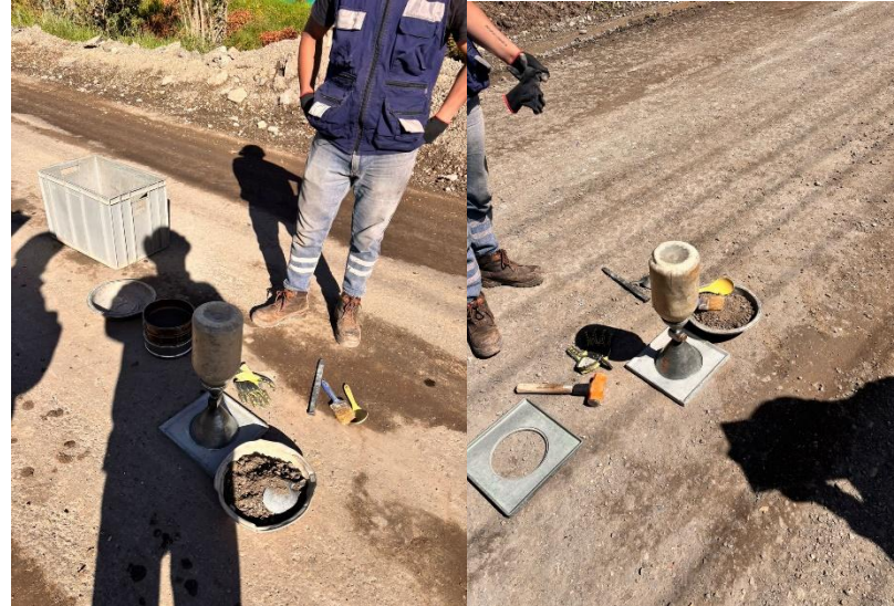
Ilustración 30, 31 y 32, Toma de Densidades de Campo
