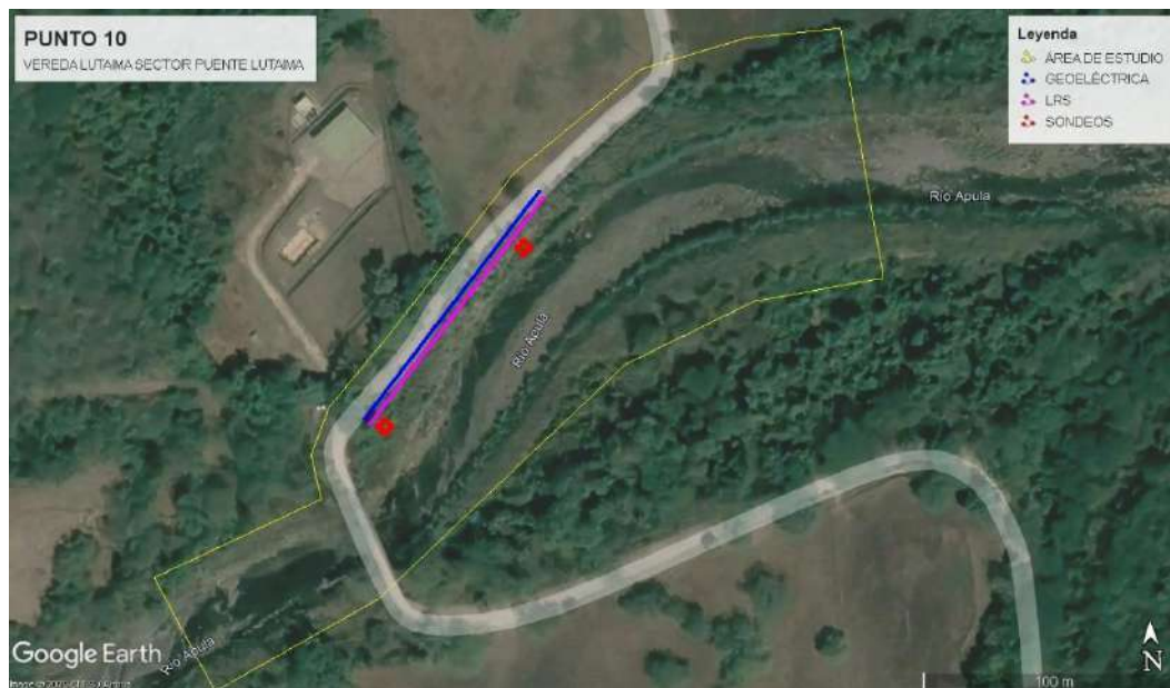
Figura 3. Delimitación de área de estudio preliminar y localización de sondeos, líneas de refracción sísmica y tomografía eléctrica punto 10
