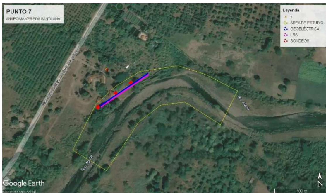
Figura 1. Delimitación de área de estudio preliminar y localización de sondeos, líneas de refracción sísmica y tomografía eléctrica punto 7
