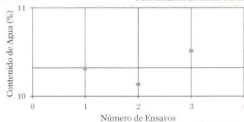
Determinación del Límite Plástico
