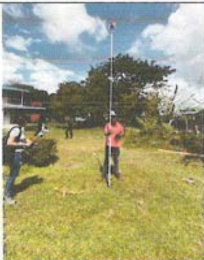
Fotografía 5. Localizacion y replanteo topografico mediante uso de estacion RTK con antena GPS
