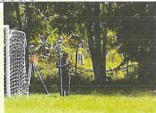
Fotografía 5. Localizacion y replanteo topografico mediante uso de estacion RTK con antena GPS
