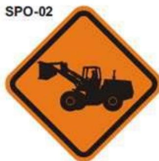
Figura 2. Señalización Maquinaria en la vía (SPO-02)
