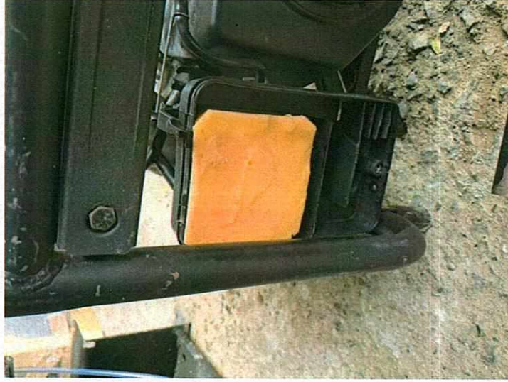
F - 6 CAMBIO FILTRO DE AIRE
