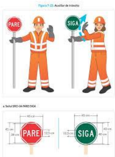
Ilustración 6. Señalización para control de tránsito.
