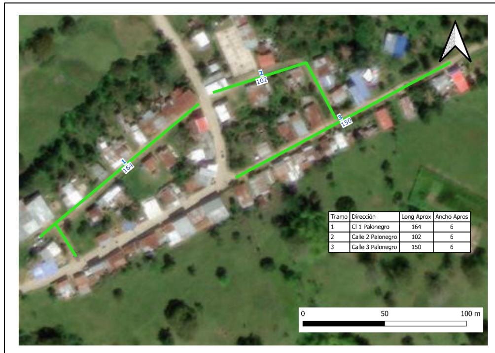
Figura 6. Imagen Satelital donde se definen los tramos a intervenir en la vereda de Palonegro.
