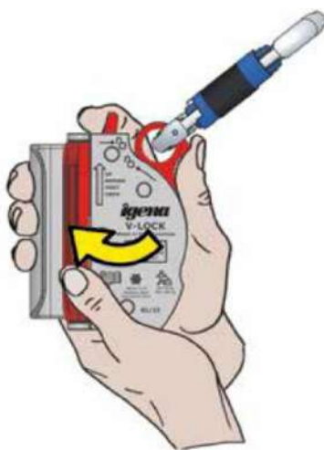
3. Rotación de la compuerta e introducir el cable dentro del anticaídas.
