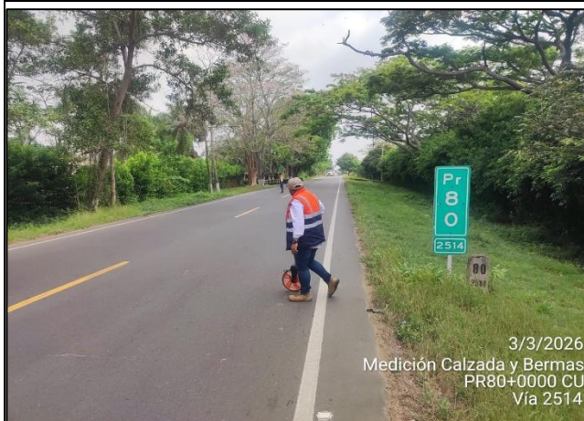
Trabajo de Campo: Mediciones e inspecciones para la determinación y calificación del estado de la red vial.
