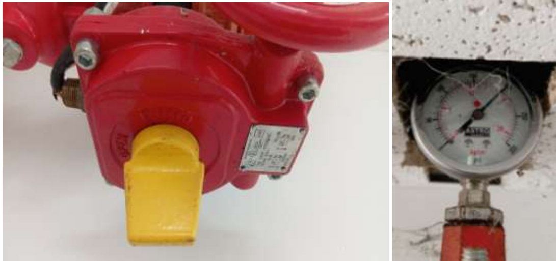
Prueba hidroestatica con manometro en 200 PSI.
