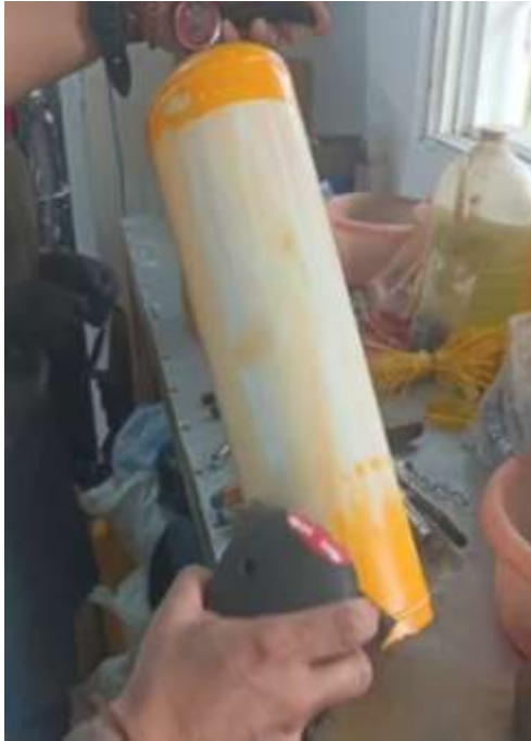
Mantenimiento a extintores deteriorados en pintura, y accesorios
