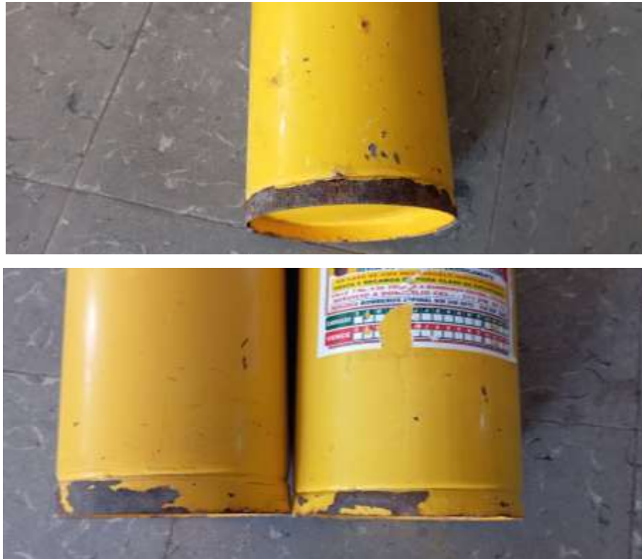
Extintores con deterioro en pintura
