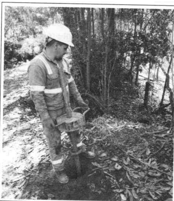
Ilustración 6. Perforación manual Sondeo 1
