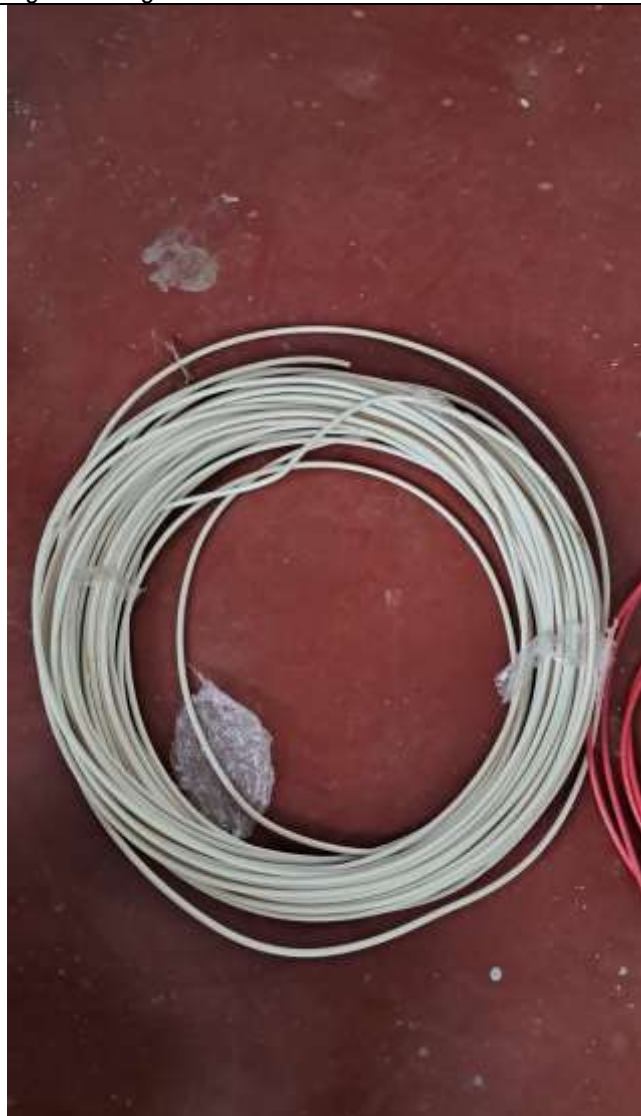
Foto 1: instalación de alambre de Cobre THWN N° 14 AWG color blanco
