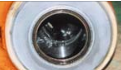
WC Pulverización térmica
