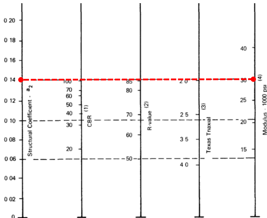
Ilustración 21. Grafica Coeficiente estructural para bases granulares sin tratar (Fuente: metodología AASHTO-93)
