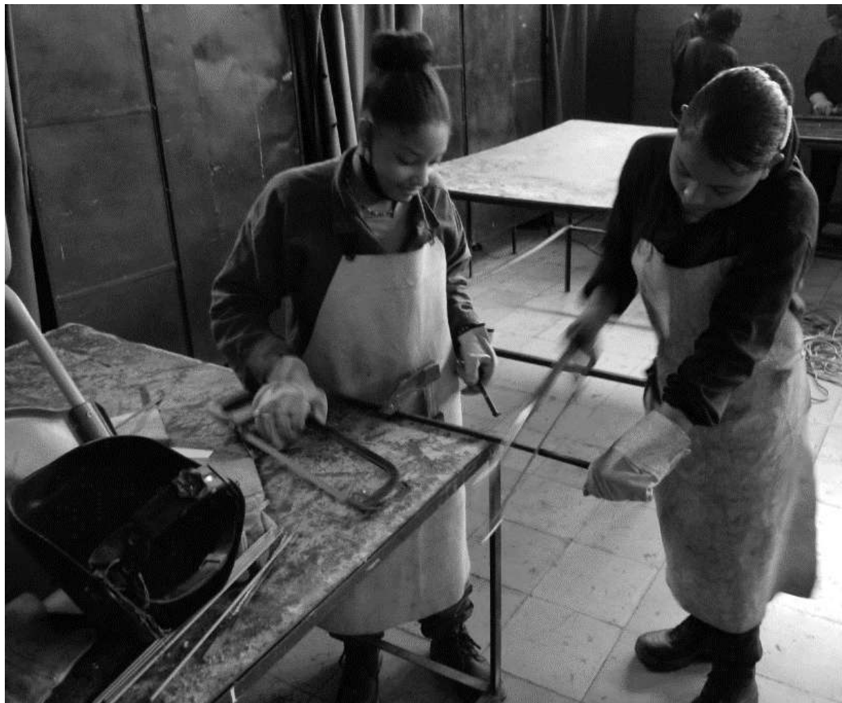
Fig 7. Ejecutando proceso trazado y corte manual dando el máximo aprovechamiento al máximo del material_ficha: 3157626 Abril 23 de 2026
