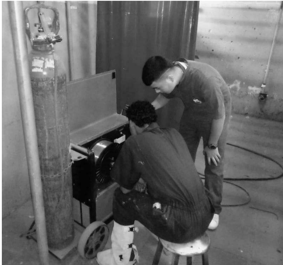
Fig 9. FPI configuración de parámetros en el proceso MIG_MAG para soldar láminas de acero de espesores delgados Abril 24 de 2026
